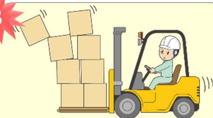
バランスの悪い積付け による荷崩れ
